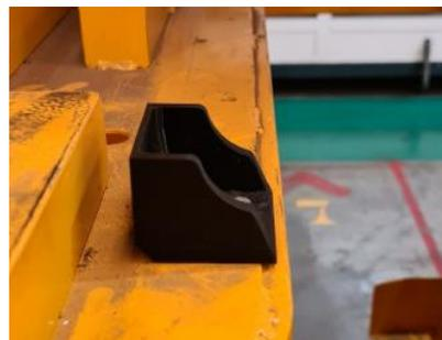
2. Soporte trasero izquierdo → replicar el soporte de la figura añadiendo 10mm de material en las paredes, no en su base.
